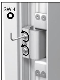
1. Befestigungsschrauben lösen.
