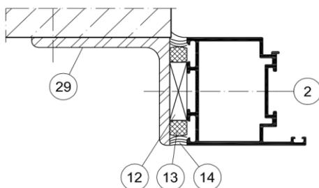
Anschluss an Stahl-Rohr
