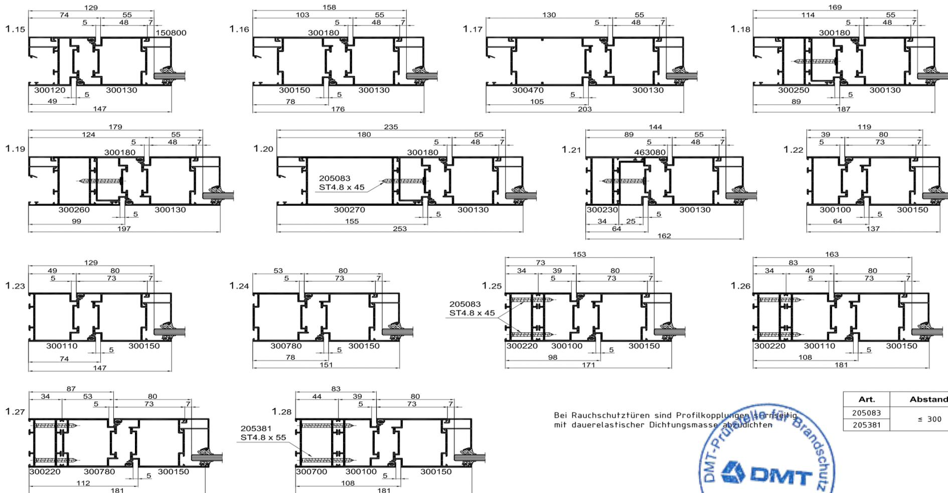
Bei Rauchschutztüren sind Profilkopplungen doppelseitig mit dauerelastischer Dichtungsmasse abzudichten
