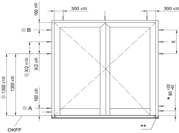
\* zusätzliche Anker / Dübel bei Türen ohne Bodeneinstand bzw. Bodenschwelle
