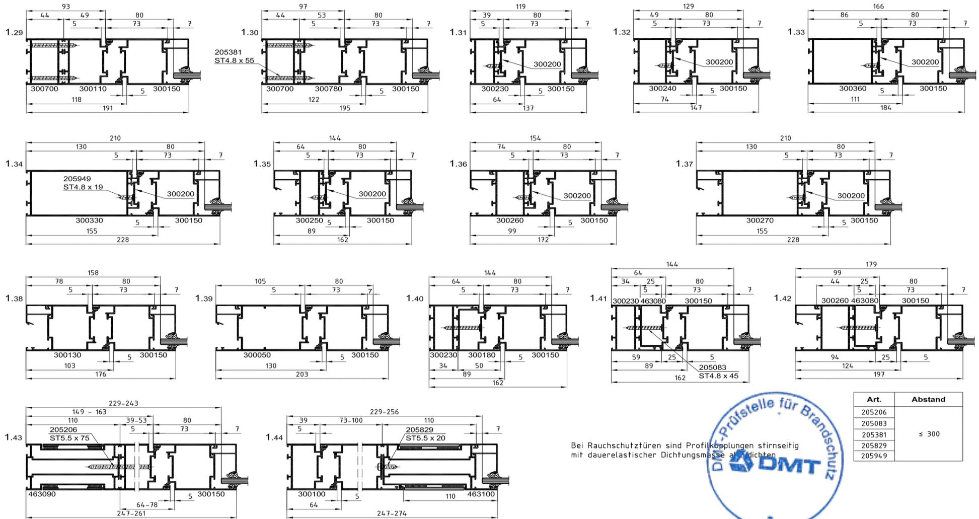
Bei Rauchschutztüren sind Profilkopplungen stirnseitig mit dauerelastischer Dichtungsmasse abzdichten
