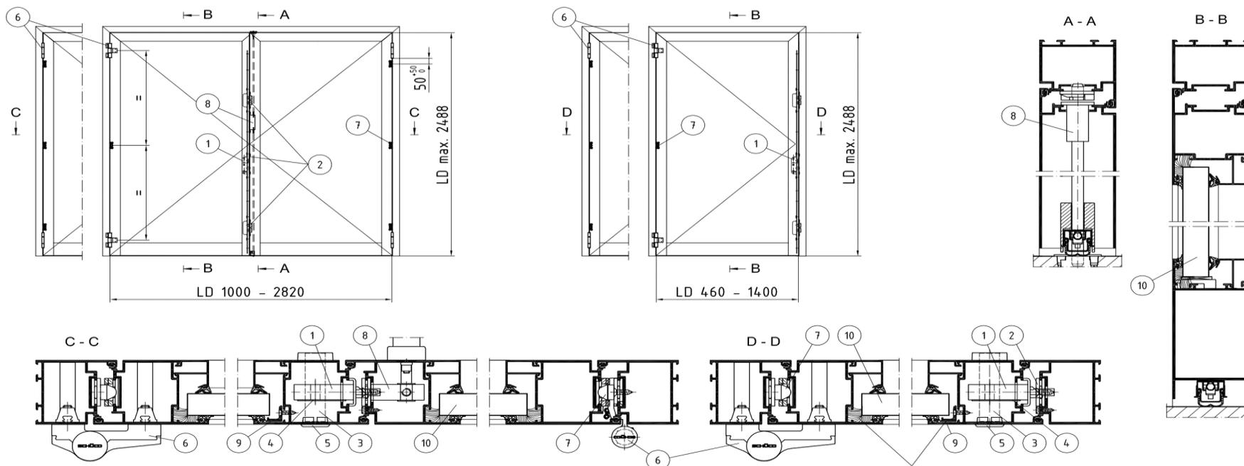
Die Verklebung des Glases kann durch eine Glasfalz-sicherung ersetzt werden
