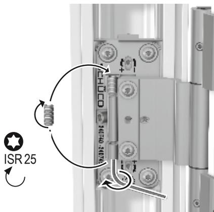
3. Gewindesttift unten herausdrehen und oben einsetzen
