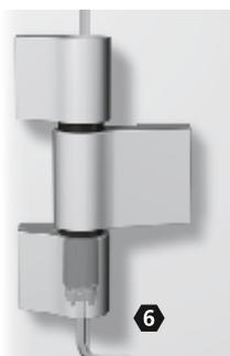
6. Mit Verstellstern untere Lagerbuchse um  $\pm 90^\circ$  drehen bis sie spürbar einrastet
