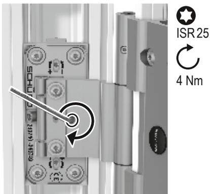
5a. Schrauben drehen, max. 3/4 Drehung
