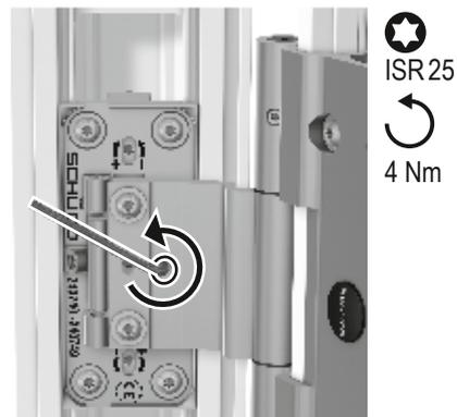
5b. Schrauben drehen, max. 3/4 Drehung
