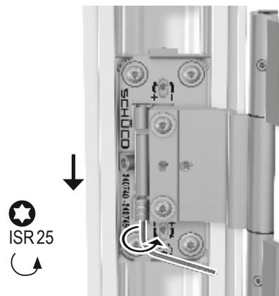
2. Gewindesttift unten einsetzen, eindrehen und Flügel absenken
